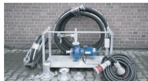
Pumpen, Schläuche, Flansche, Leistungskabel
